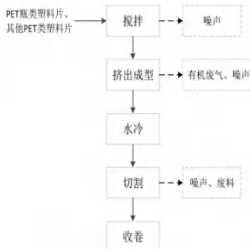
图 2-5 塑料片材产品生产工艺流程图
