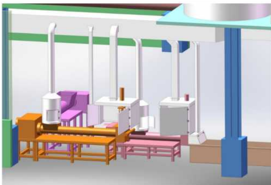
图 4-6 废气收集示意图
