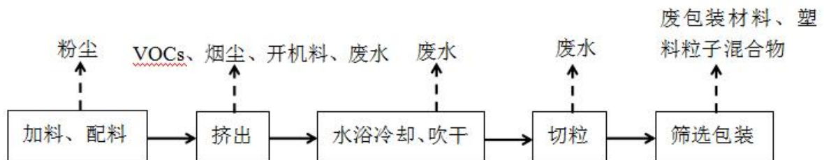
图 3-4 聚碳酸酯共混料生产工艺流程及产污环节
